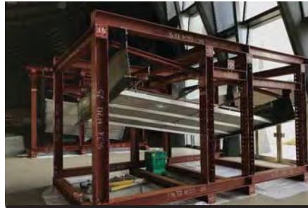
緩勾配天井試験体 1体
