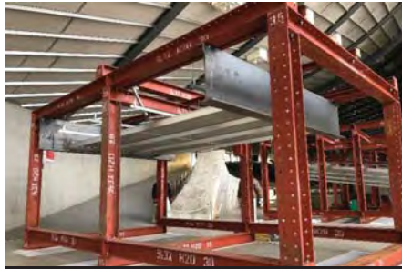
無勾配天井試験体 3体
