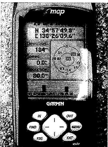
【図2：GPSの衛星画面。右中央の円が描かれた画面が衛星配置を表している。中央が天頂であり、そこに近いほど衛星が捕捉しやすい。また下の棒グラフは高いほど良好な電波が捕捉できていることを示している。現在2つの衛星からのみ良好な電波を捕捉しているため、誤差(accuracy)も80mと大きな値となっている。上部に示されている数字が北緯と東経である】
