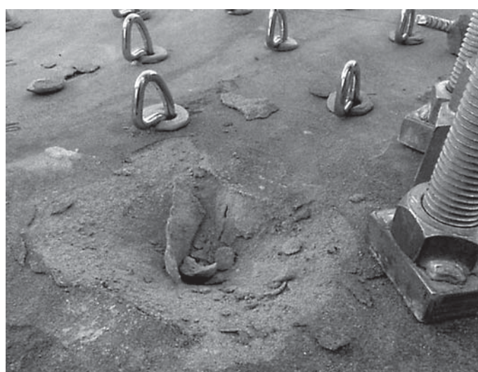
図5 ボルトの軸方向引抜き試験の様子と軟質な砂岩に設置したボルトの試験後
