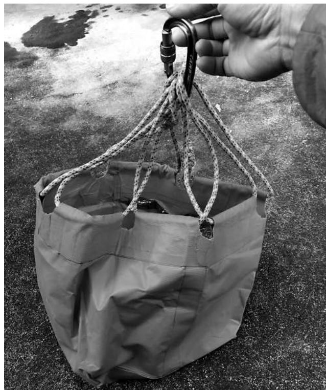
写真9 フローティングアンカー
