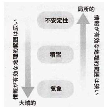
図21 雪崩ハザード評価の3つの要素 （『雪崩教本』より引用）
