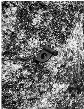
写真5 瑞牆山で見られる老朽化が進む支点
