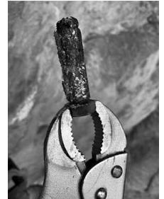
単純に径についても、リングやRCCのような細いものでは、強度的に弱いことは、かなり早い段階で周知の知識となった。現在では、M10を最低のものとし、岩質によってはM12のボルトが使用されてい
