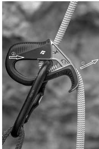
図3：ATCパイロットでの制動（ロストアローHPより）。①の方向にサムレバーを引き上げてロープをリリースする。また、何らかの力が②の方向に加わると、ロープは簡単にリリースされてしまう。
