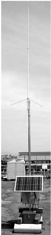
長野県駒ヶ根市役所の屋上に設置された通信システムの中継機＝不破泰・信大教授提供
