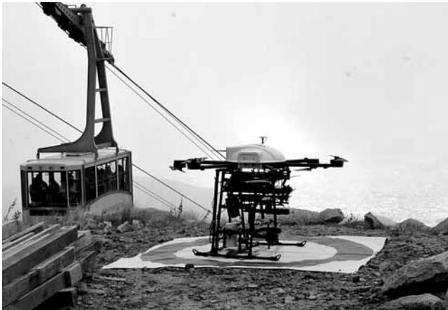
4Kカメラや拡声機を搭載したドローン＝長野県駒ヶ根市の中央アルプス千畳敷、松下和彦撮影
