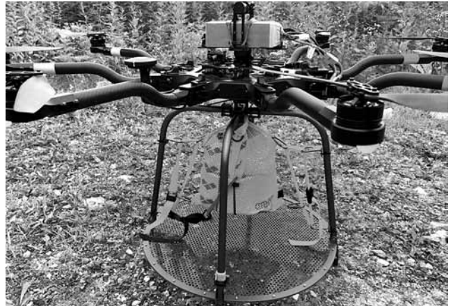
2019年に白馬村で行われた実証実験で使用されたドローン。レタスなど体積のあるものを収容できるようネットが取り付けられている＝白馬村山岳ドローン物流実用化協議会提供
