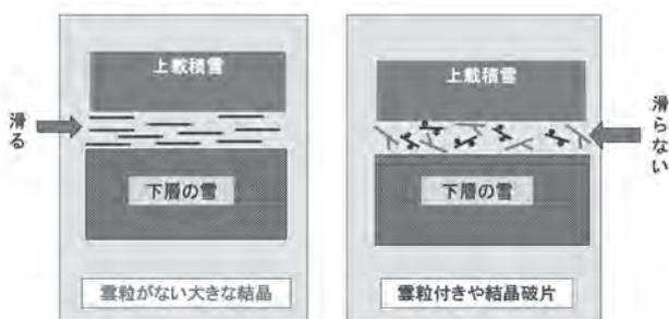
図16 降雪結晶による弱層形成の模式図
