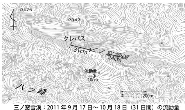
図5 三ノ窓雪渓の氷体の流動量
