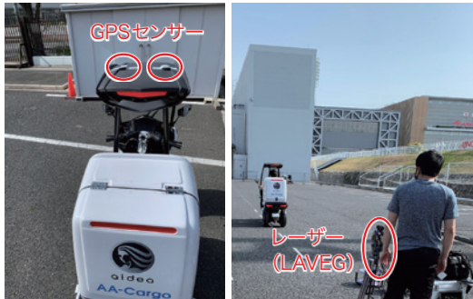
図5 三輪バイクを用いたGPSセンサーの精度検証
