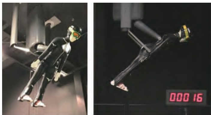
写真 平昌 2018 大会に向けて開発したスキージャンプスーツの風洞実験（2017 年 8 月）
