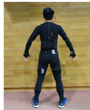
写真 モーションキャプチャー検証実験におけるスーツと反射マーカの取付
