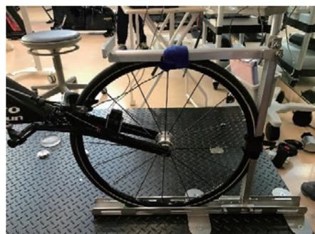
写真 レーザー固定方法（前輪部）
