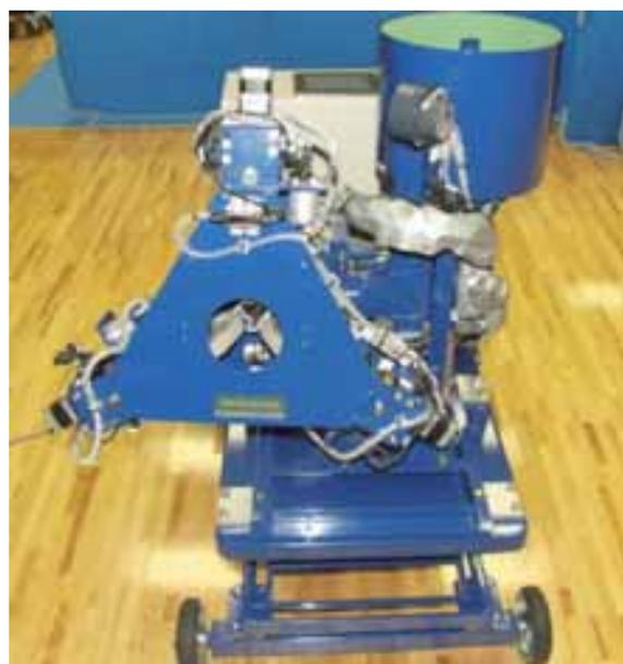
写真3 マルチサポート事業にて開発された3ローター式卓球マシン
