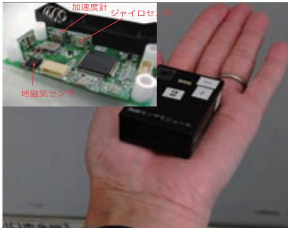
写真 作成した9軸センサー
