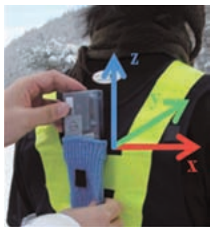
図1 センサロガー装着時の様子と計測軸の方向
