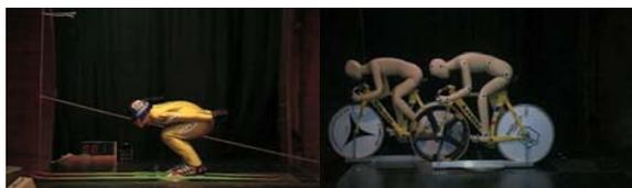
図1 風洞実験室内でのトレーニング（スキー・ジャンプ）及びチームスプリントでの走者交代時をシミュレートした風洞実験（自転車競技）
