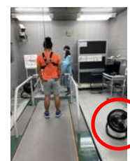
サーキュレーターを2台設置し、空気が滞留しないようにする
