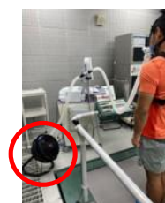
サーキュレーターを2台設置し、空気が滞留しないようにする
