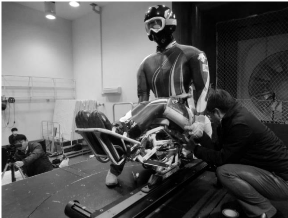
図 4-21 風洞内に固定された人形模型（カウル無し）
