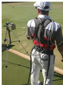
図5 磁気センサー式モーションキャプチャーの例 (Polhemus社製、LIBERTY)
