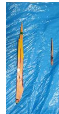
写真3 剥離した木片
