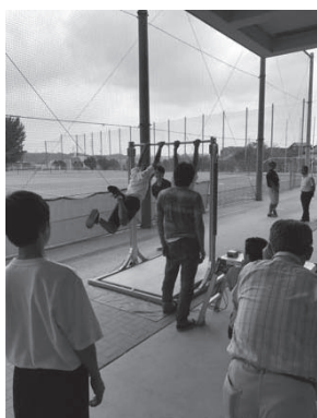
図1：ぶら下がりによって発生する力の計測実験(左)と、ゴールの転倒実験(右)
