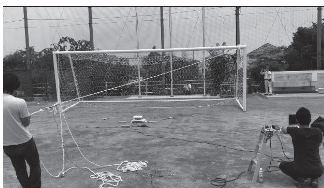
図1：ぶら下がりによって発生する力の計測実験(左)と、ゴールの転倒実験(右)
