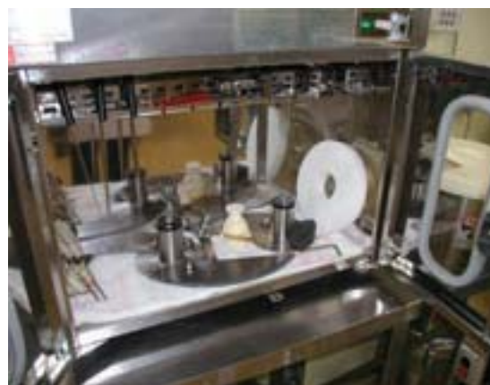
〈悪い例：保管庫の底に接している面には紫外線が照射されない〉
