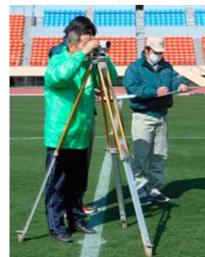
レーンの角度を計測(トランシット)
