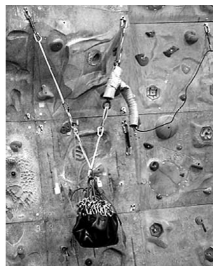
図2 アンカーに掛かる荷重の測定
